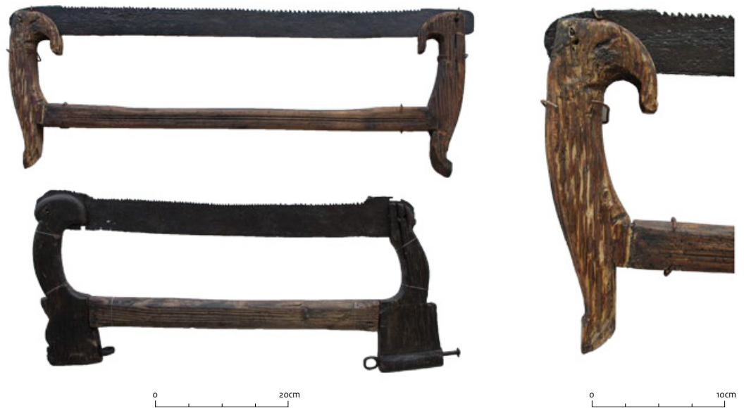
Afb. 4.48 Twee spanzagen. Rechts: detailopnames van zaaggreep met zaagblad (catnr. 106 en 107) (foto's: S. Lange).
