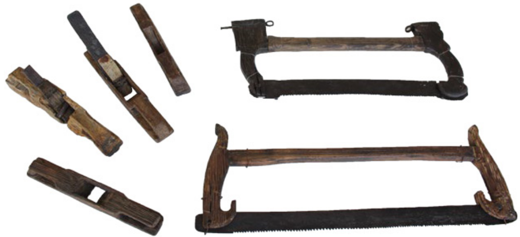
Afb. 3.25 Twee spanzagen en vier blokschaven uit het scheepswrak De Meern I (foto: Silke Lange).
